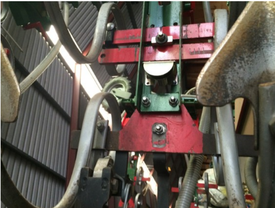
Billede 2. Billedet viser spredepladen monteret, så frøene spredes bagud og lander på jorden efter skærene men før efterharven. Frøene harves delvis ned i jorden af efterharven på radrenseren. Foto: Claus H. Jensen, Thyregod A/S.
