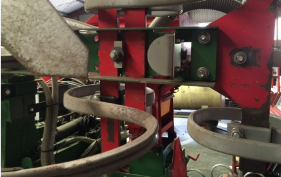
Billede 1. Billedet viser spredepladen (pil) monteret, så frøene spredes fremad og lander på jorden før skærene på radrenseren, så frøene renses ned i jorden. Foto: Claus H. Jensen, Thyregod A/S.
